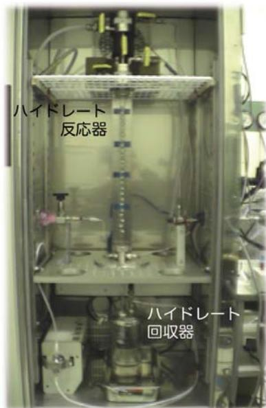
図3. ハイドレート生成回収実験装置
