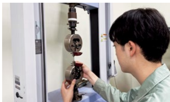
引張試験による金属材料の機械的特性評価 Evaluation of mechanical properties on a metallic material by tensile test
