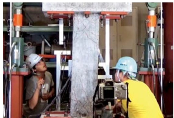
鉄筋コンクリート柱の破壊実験 Collapse test of reinforced concrete column
