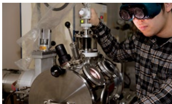
アルゴン・アーク溶解法による試料作製。この方法で多くの金属間化合物が合成される。 The Ar arc-melting, which is one of sample preparation methods. Many intermetallic compounds are prepared by this method.
