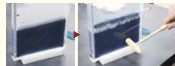
▲振動を与えると砂(白い部分)が沈み、水(青い部分)が押し上げられる。砂が動いていることがわかる。
