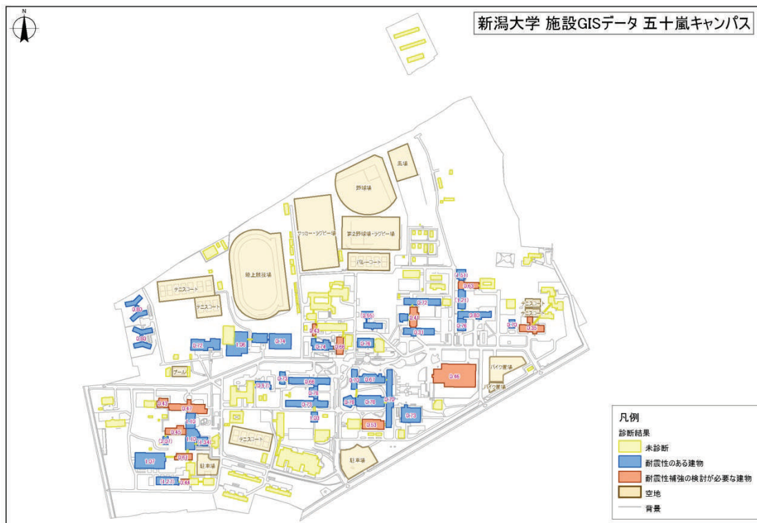
図 21 新潟大学における建物の耐震診断状況（五十嵐キャンパス）
