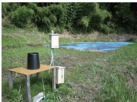
図 1-3 現地に設置した水位計及び雨量計
