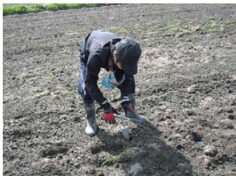
図 2-3 土壌試料の採取
