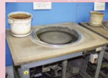
研磨機 岩石を薄く削るために使用
