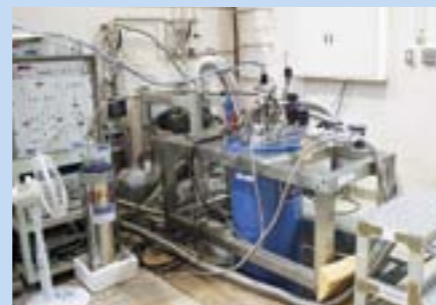
※高性能冷凍機とは? 液体ヘリウム(4He, 3He)を使い、様々な物質をほぼ絶対零度まで冷やすことができる実験装置。
