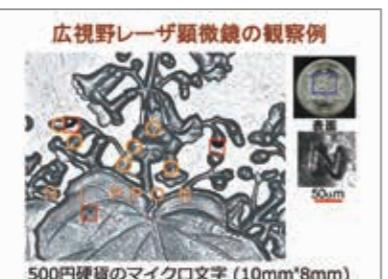
↑500円硬貨の表面。赤格子が同倍率の光学顕微鏡の1視野。新田教授が開発した顕微鏡は約400倍広い視野の観察が可能
