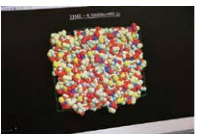
↑溶液内のイオンの動きをシミュレーションを用いて可視化する
