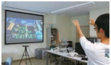
↑現実世界の行動をCGの世界で表現する試み。関節の動きをデータ化し、バスケットボールのシュートモーションをするとスクリーン内でボールが投げられる
