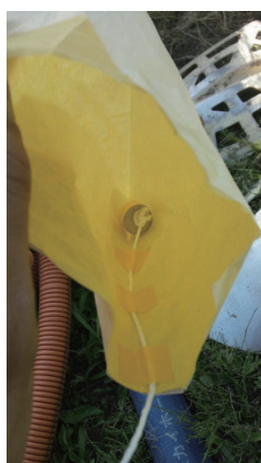
図2 果実袋内に設置した小形温湿度センサ
