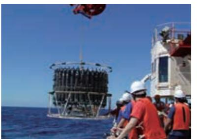
▲サンプリングに使用するCTDクリーンマルチ採水システム採水器
