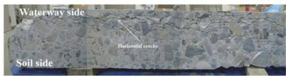
図1 凍害損傷が顕在化した鉄筋コンクリート部材(水利施設)
