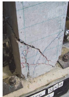
再現された試験体の損傷(右)
