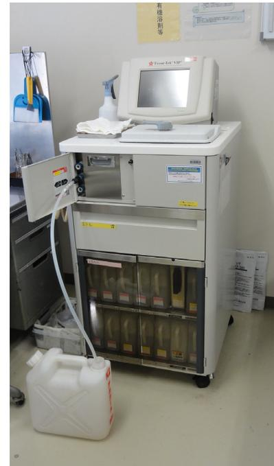
図2 自動包埋装置チューブを通して薬液交換をしているところ。
