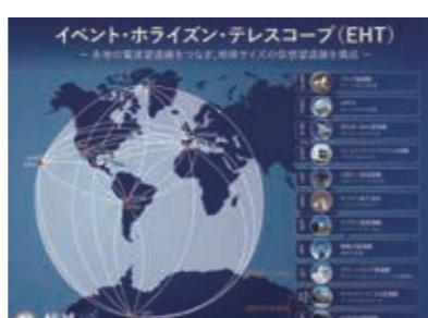
↑EHT望遠鏡配置図(2018年以降)。いて座A\*等を撮影した2017年の8局から増え現在は11局に。「1億年に1秒しか誤差がない」といわれる原子時計を用いて撮影される
