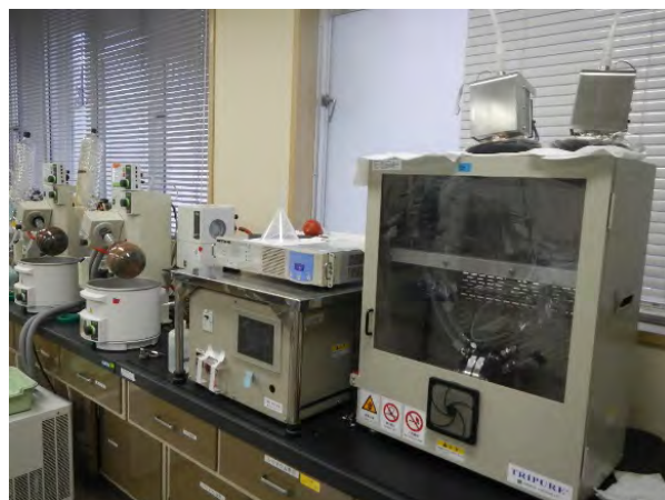
トリチウム電解濃縮装置
