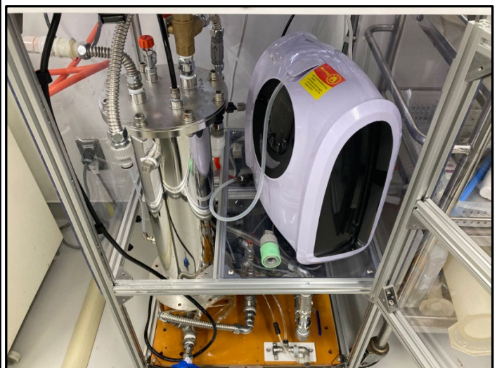
写真4 オゾン・ナノ水の製造装置(開発中のプロトタイプ)
