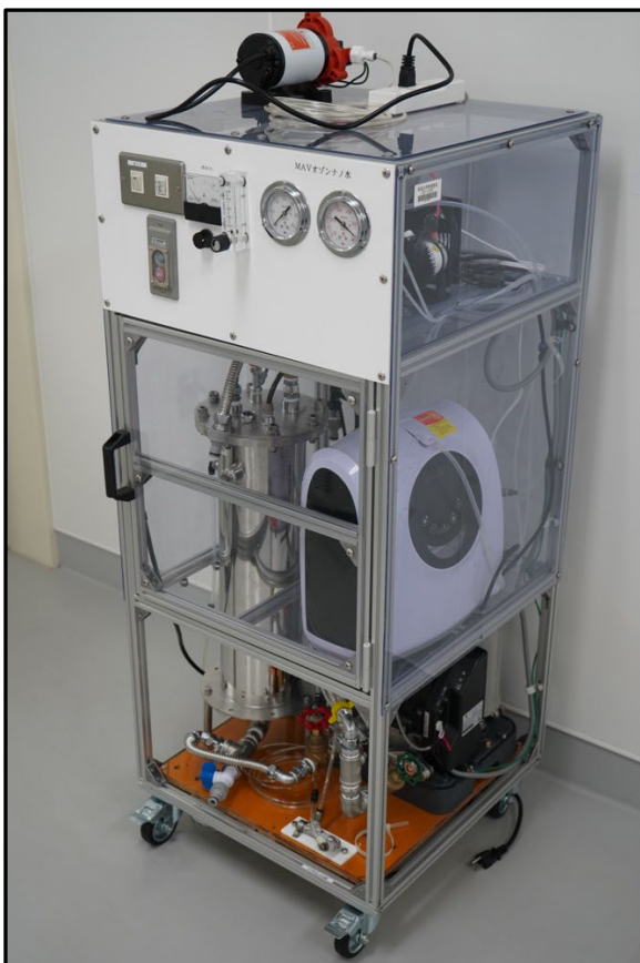
写真4 オゾン・ナノ水の製造装置(開発中のプロトタイプ)
