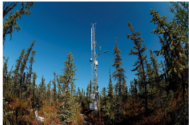
図 1 米国アラスカ州フェアバンクス永久凍土上のクロトウヒ林に設置された、森林の CO 2 吸収を評価するための気象観測タワー。
