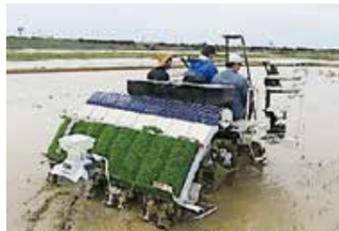
可変施肥田植機による水稻機械移植(新通ステーション)
