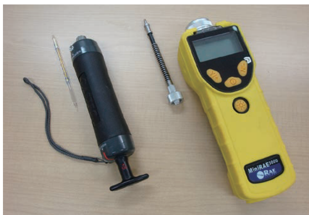
検知管式(左)とPID式(右)気体検知器
