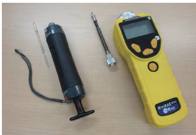
検知管式(左)とPID式(右)気体検知器
