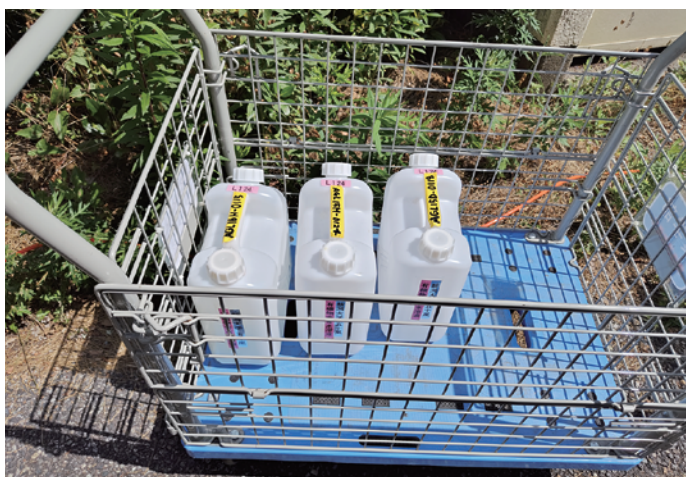
番号で管理された廃液用ポリタンク
